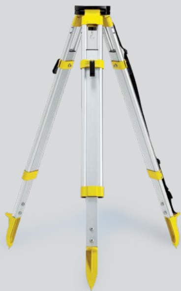
Trépied avec base ronde CTP104 Trépied en aluminium avec sangles de transport, fixations rapides,, vix 5/8". Extensible 85 à 160 cm Référence 767 710
